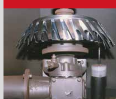
Fig. 4-8 Lance Peening of Fan Disk
